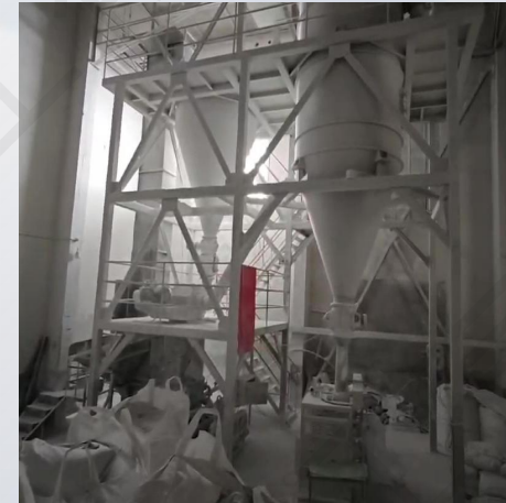
气流式磨粉机 D50: 5.5-2.7 4000目
