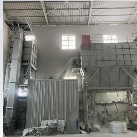
环辊式磨粉机 通过率: 90%-全通
